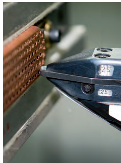
Oben: Die Stanze auf dem Weg zum Bürstenkörper – innen liegt bereits die Drahtschleife mit dem Bündel Borsten. Unten: Das Bündel ist samt Drahtschleife in den Körper gestanzt worden.
