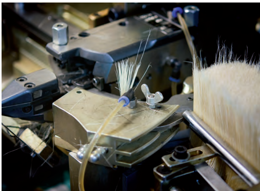
Links zu sehen: Die Spitze der Stanze, die aus dem Reservoir rechts jeweils ein Bürstenbündel zugeführt bekommt. In der Mitte ein Bürstenbündel auf dem Weg zur Stanze.
